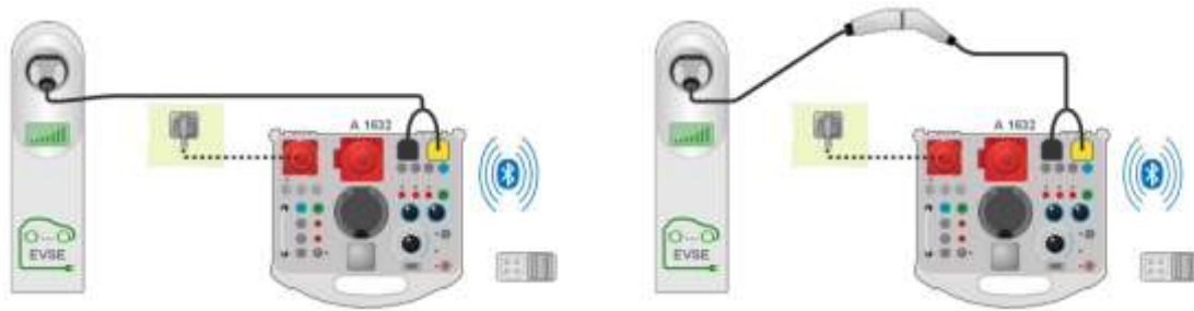
Diagnosetest – Anschluss an EVSE
