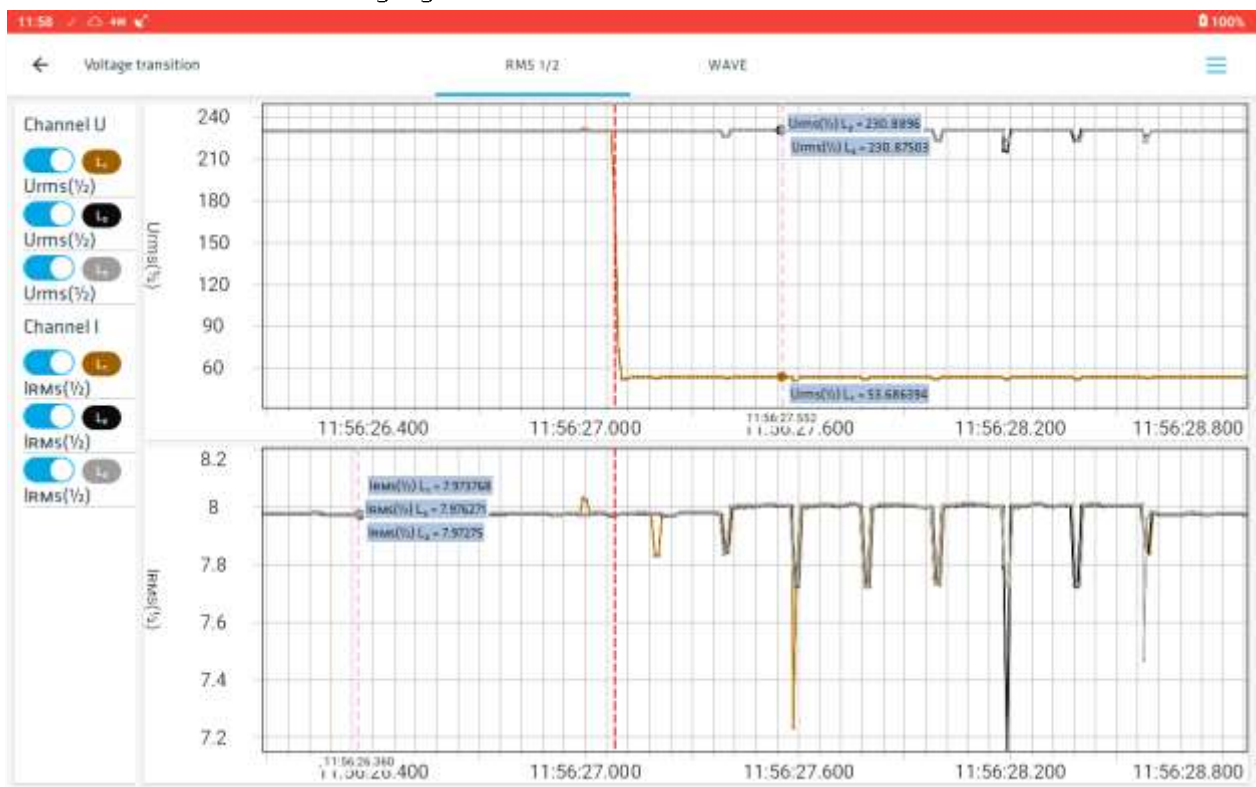
Abbildung 56: Ansicht der Übergangsdetails von RMS 1/2
