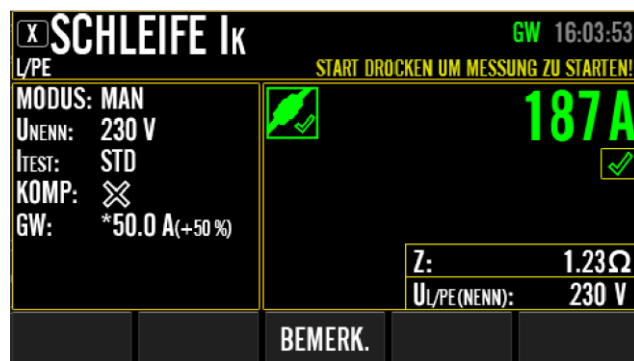
Abbildung 26: Endergebnis bei der Messung SCHLEIFE I_k (L/PE), Beispiel
