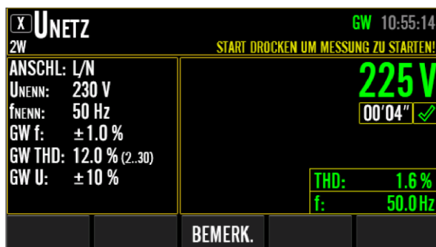
Abbildung 113: Endergebnis in UNETZ-Messung, Beispiel
