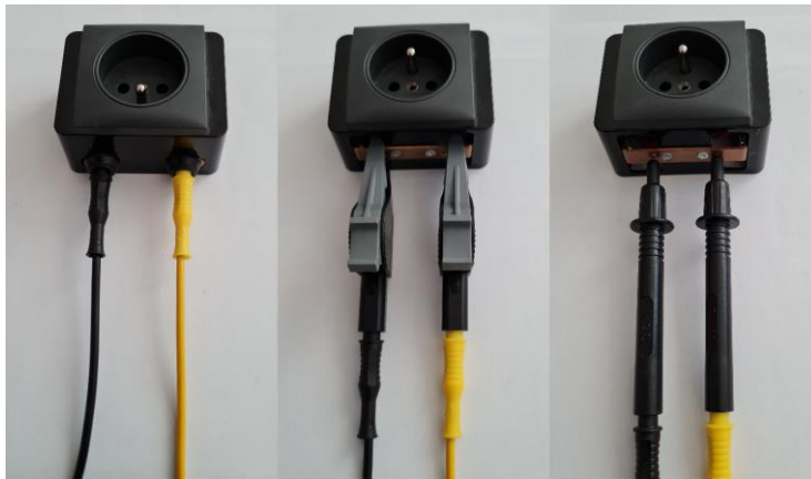
Abbildung 7: Anschluss von zwei Messleitungen mit Bananenstecker (linke Abbildung), mit Testkrokodilklemme (mittlere Abbildung) oder mit Prüfspitze (rechte Abbildung) an den Zero Adapter ZA-204-SC.
