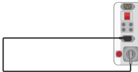
Abbildung 6.21: Kompensation zwischen Netzprüfsteckdose und IEC Steckdose
