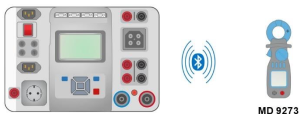
Abbildung 8.6: Anschluss des Leckageklemmenmessers mit Bluetooth®-Kommunikation
