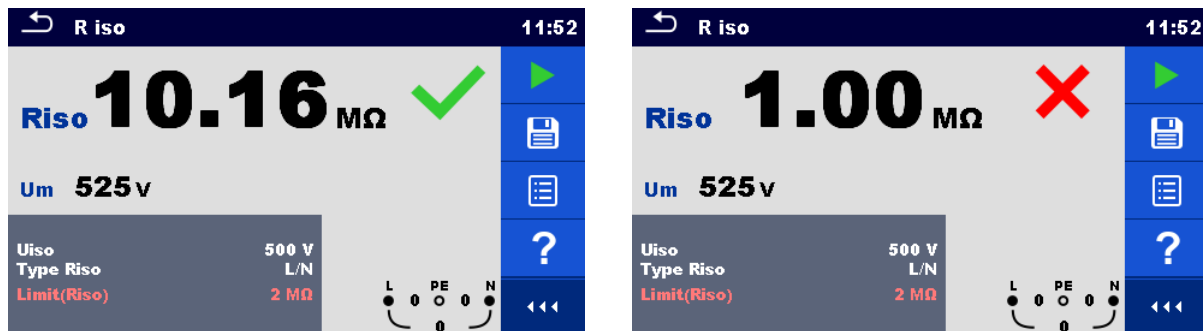
Abbildung 6.32: Beispiele für Ergebnisse der Isolationswiderstandsmessung (Installation)
