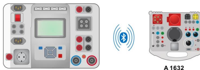
Abbildung 8.5: Verbindung des eMobility Analyser (A 1632)
