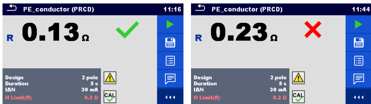
Abbildung 6.119: Beispiele für Ergebnisse der Schutzleiterprüfung (PRCD)
